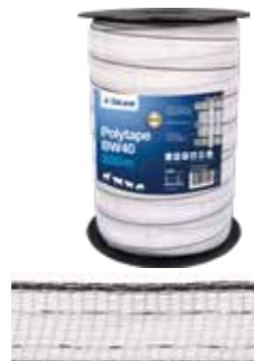
Polybånd BW40 sort/hvid L: 200 m, Ø: 40 mm, C: 2 CU/5 SS, R: 0,08
