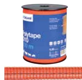
Polybånd O10 Orange L: 200 m, Ø: 10 mm, C: 1 CU/4 SS, R: 0,35
